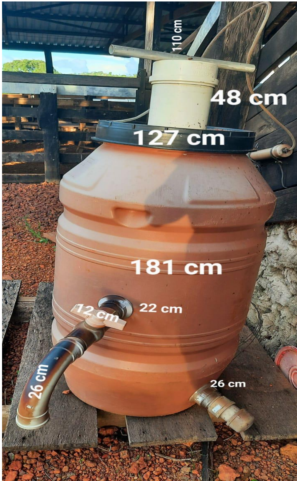
Figura 4 - Medidas, em cm, da montagem do biodigestor
